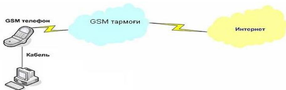
Рис. 4.4. Подключение к Интернету через мобильную связь.
